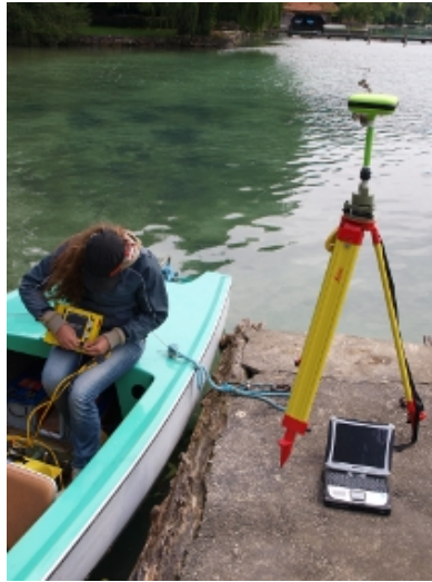
Abb. 2.2: Aufbau des GPS-Systemes für die Messungen mit dem Bodenradar
